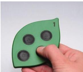
Funktechnik ist heute allgegenwärtig. Alles ist mit allem drahtlos verbunden. Selbst Lichtschalter funktionieren heute ohne Kabel, was vor allem für nachträglichen Einbau in Häusern ein grosser Vorteil ist, entfällt doch das Aufspitzen der Wände. Wenn die Geräte jetzt auch noch die Batterie loswerden, entfallen Wartung und Entsorgung der schadstoffbehafteten Batterie. Dies kann man erreichen, indem man der Umwelt die Energie entzieht.
