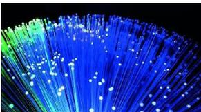
Le fibre ottiche sono fini come un capello, ma permettono di trasmettere un'enorme quantità di dati a grandi distanze. Cavi ottici lunghi migliaia di chilometri attraversano i paesi e gli oceani permettendo la trasmissione delle telefonate, della musica, dei programmi televisivi e dei gattini di Facebook.
