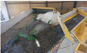
Studiare la capacità di uno sfioratore a calice. Approfondire la teoria per la costruzione di una rampa dinamica. Analizzare dei sistemi fluviali complessi e con parecchie infrastrutture antropiche. Questi sono alcuni esempi delle circostanze in cui è necessario ricorrere alla modellizzazione fisica per avere una visione più precisa del problema.
