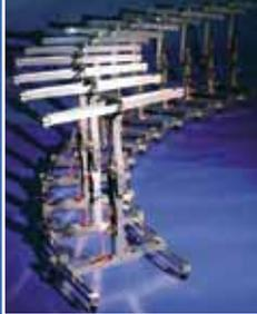
◀ Grâce à une tige verticale qui effectue un mouvement de va-et-vient, «Stumpy» peut se déplacer d'une manière assez naturelle.
