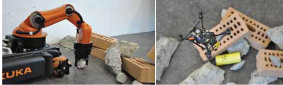
Le robot volant est équipé de capteurs supplémentaires: une caméra fournit des images du lieu de l'accident.
