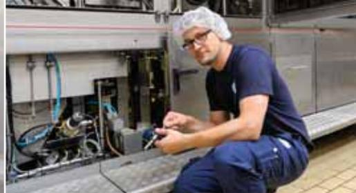
▲ Une vis à billes utilisée pour le scellage de la ligne de soudure du fond est remplacée. Je vérifie le fonctionnement de la pièce de rechange.
