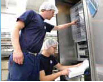
Die Abfüllmaschine erreicht die gewünschte Temperatur nicht. Mein Bruder und ich entnehmen dem elektrischen Schema die Bezeichnung des Solid State Relais.
