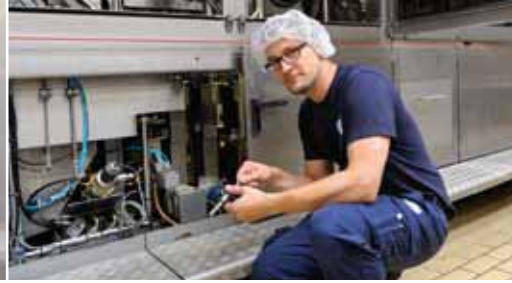
▲ Eine Kugelumlaufspindel für die Bodennaht-Verriegelung wird ersetzt. Ich überprüfe die Funktion des Ersatzteils.
