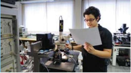
▲ Dimitra commence par examiner les minuscules MEMS au laboratoire avec l'analyseur de réseau avant qu'elles ne soient intégrées dans des antennes.
