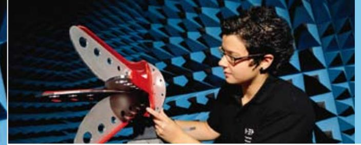
▲ L'antenne de test commerciale n'est utilisée que dans la chambre de mesure et doit être orientée avec précision.
