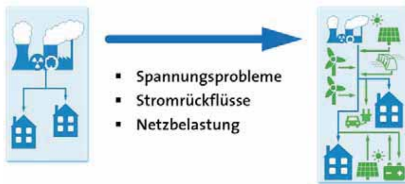
Abbildung 5 – Neue Herausforderungen im Verteilnetzbetrieb (ETH/Adaptricity).
