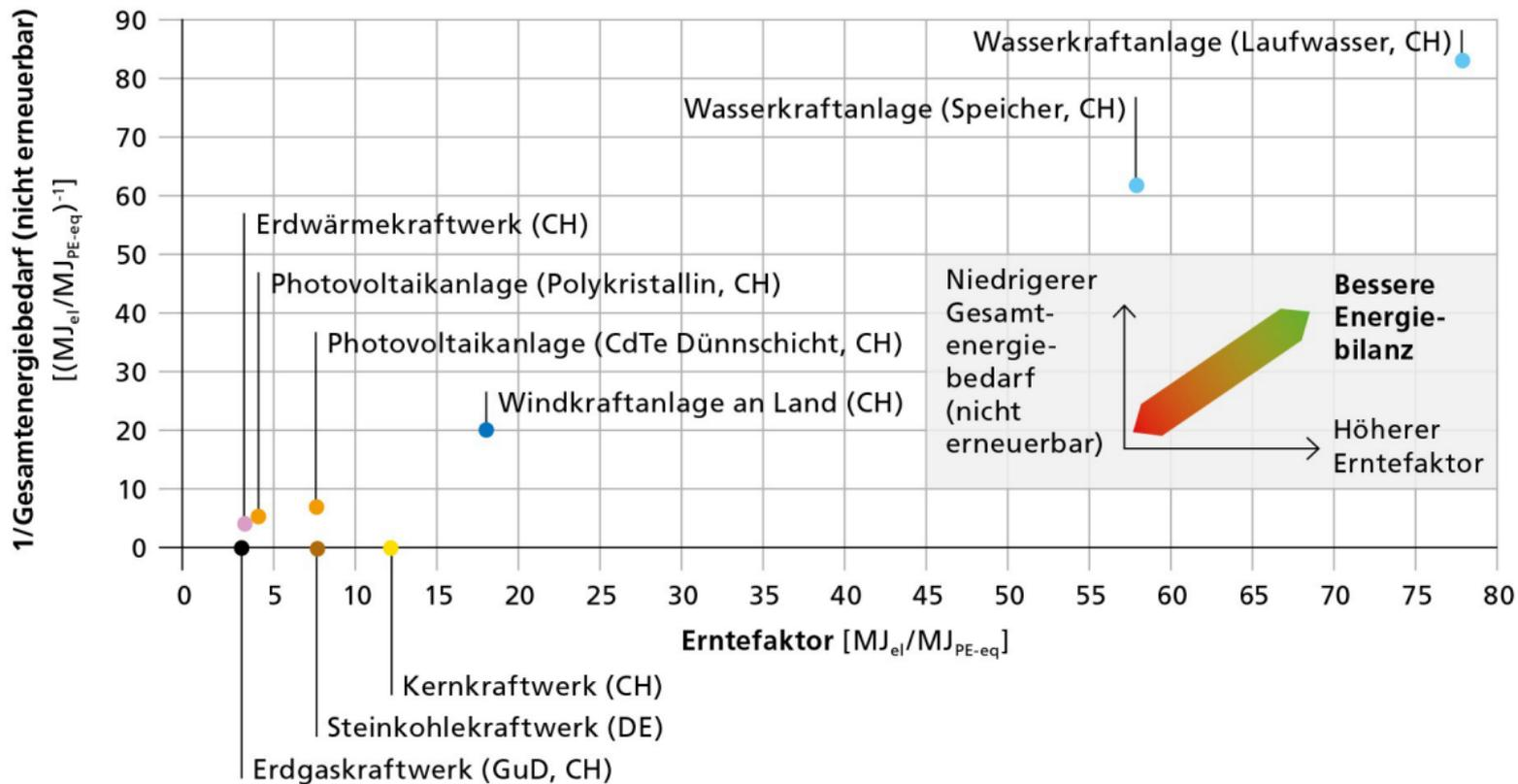
**Abbildung 1:** Die Gesamtenergiebilanz, ermittelt aus den Kennzahlen «Gesamtenergiebedarf (nicht erneuerbar)» und «Erntefaktor (EROI)», zeigt ein deutliches Bild: Die Wasserkraft schlägt alle übrigen Arten der Stromerzeugung um Längen. Doch auch Photovoltaik und Windkraft schneiden gut ab.
