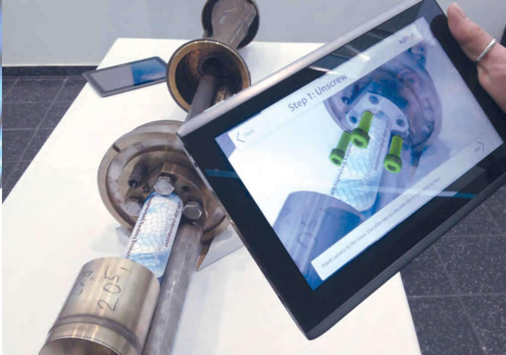
Abbildung 1: Proof of Concept einer AR-Serviceanwendung für Revisionsarbeiten; Projekt-kooperation des Alstom Future Technology Program mit der FHNW, Institut für 4D Technologien, 2014. (Abdruck mit freundlicher Erlaubnis von Alstom Switzerland Ltd.)
