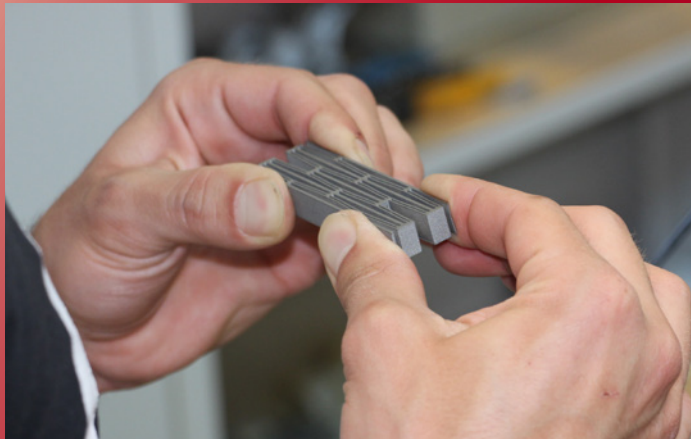
Componente modello di una struttura reticolare in acciaio a memoria di forma
