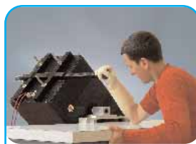
Au bras de fer, le robot est fort : ses quatre paquets de muscles lui permettent de lever une masse d'environ 120 kg.
