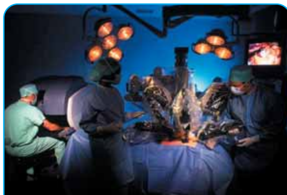
Operationsroboter: Der Chirurg führt die Operation sitzend durch. Auf dem Bildschirm oben rechts kann die Operation verfolgt werden.
