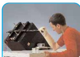
Der Armroboter ist stark: Mit seinen vier künstlichen Muskelpaketen kann er eine Masse von etwa 120 kg heben.
