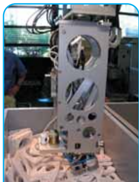
La pince IMA équipée de capteurs (à gauche) et d'une matrice de préhension (en bas)
