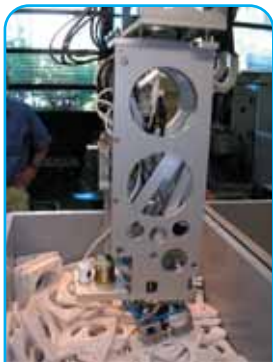
Der IMA-Greifer mit Sensoren (links) und Greifmatrix (unten)
